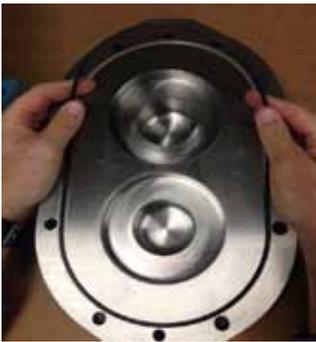
2. Saca la tapa de la bomba. Si pegado, sueltala de pegando suavemente con un martillo. Saca y bota o-ring de la tapa. (Figura 27)
